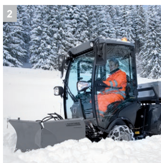
1 Концепция быстрой замены принадлежностей без инструментов
