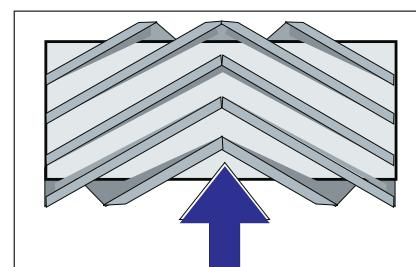
Расположение подметающего вала при установке по направлению движения (вид сверху)
