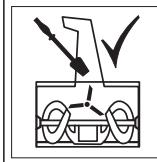
Очищать шахту выброса только с использованием моющих инструментов.
