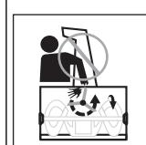
只有当扫雪机零件完全停止时方才接触它们。
