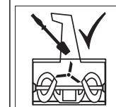
Ne nettoyer le puits d'éjection qu'avec l'outil de nettoyage
