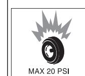
Rischio di esplosione! La pressione massima delle gomme non deve superare max. 1,4 bar/20 PSI.
