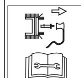
Prije svih radova, poput namještanja, čišćenja, provjere itd., uređaj isključite i izvucite utikač svjećice.
