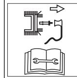
Apparatet slås av og støpselet trekkes ut før alle arbeider som innstilling, rengjøring, avtørring etc.
