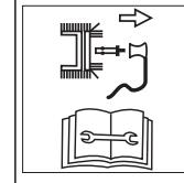
Inden der gennemføres opgaver, som f.eks. indstilling, rengøring, kontrol osv., skal maskinen afbrydes og tændrørshætten skal trækkes fra.
