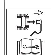
Eteindre l'appareil avant tout travail tel que réglage, nettoyage, contrôle, extinction .. et retirer la prise des bougies.
