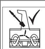
Auswurfschacht nur mit Reinigungswerkzeug reinigen.
