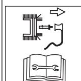
在实施诸如调整、清洁、检查等所有工作前,关闭扫雪机并拔下火花塞插头。
