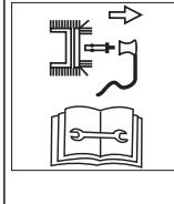
Отключать прибор после проведения всех работ, таких, как установка, очистка, проверка и т.п. и вынимать наконечник свечи зажигания.
