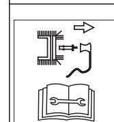
Przed wszelkimi pra- cami, np. ustawianiem, czyszczeniem, spraw- dzaniem itd., wyłączyć urządzenie i wyjąć koń- cówkę przewodu świecy zapłonowej.
