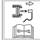
Lülitage masin enne kõiki selliseid töid nagu nt reguleerimine, puhastamine, kontrollimine jne välja ja tömmake süüteküunal välja.
