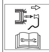
Před všemi pracemi, jako např. nastavením, čištěním, kontrolou atd., přístroj vypněte a vytáhněte nástrčku zapalovací svíčky.
