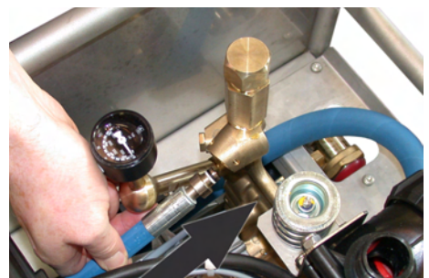
→ Sortir l'obturateur, graisser la bague d'étanchéité et enfoncer le flexible de connexion.
