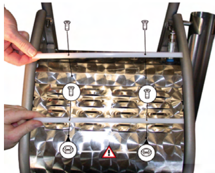
→ Mettre en place les obturateurs et visser fermement les écrous-raccords.
