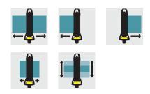
1 Регулировка расхода воды (0-макс.)
