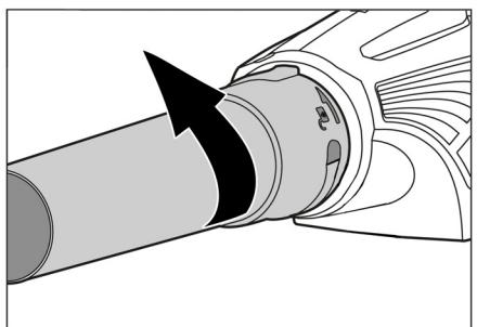
→ Okrenite ispušnu cijev ulijevo i izvadite.
