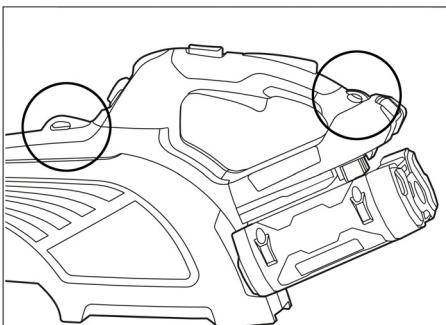
Agli occhielli è possibile fissare una cintura (non in dotazione).
