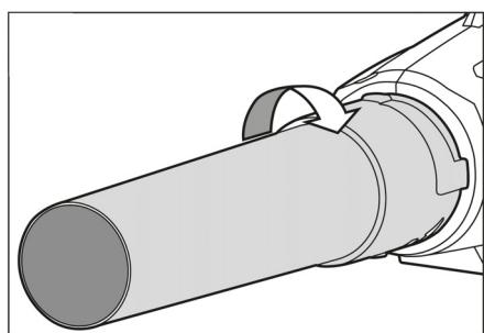
→ Draai de blaaspip om te vergrendelen met de klok mee (bajonetsluiting).
