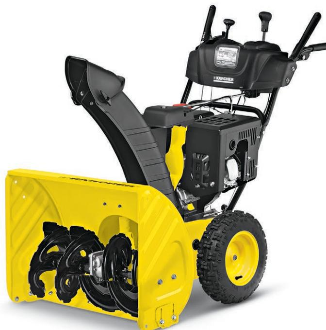
Снегоочиститель STH 8.66 W оснащен 4-х тактным бензиновым двигателем, который легко заводится в морозы и имеет низкий расход топлива. Снегоуборочный механизм с отдельными системами захвата и выброса снега отличается высокой производительностью и легко справляется даже с большими объемами слежавшегося снега. Фиксируемые рычаги облегчают управление, а тяговый привод и дальность выброса снега регулируется одним рычагом.
